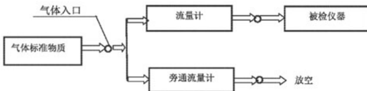
图 1 仪器气路连接示意图
