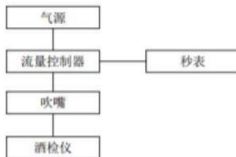
图 2 呼气流量和持续时间测量系统
