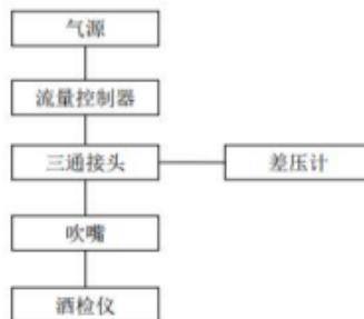
图 1 呼气阻力测量系统
